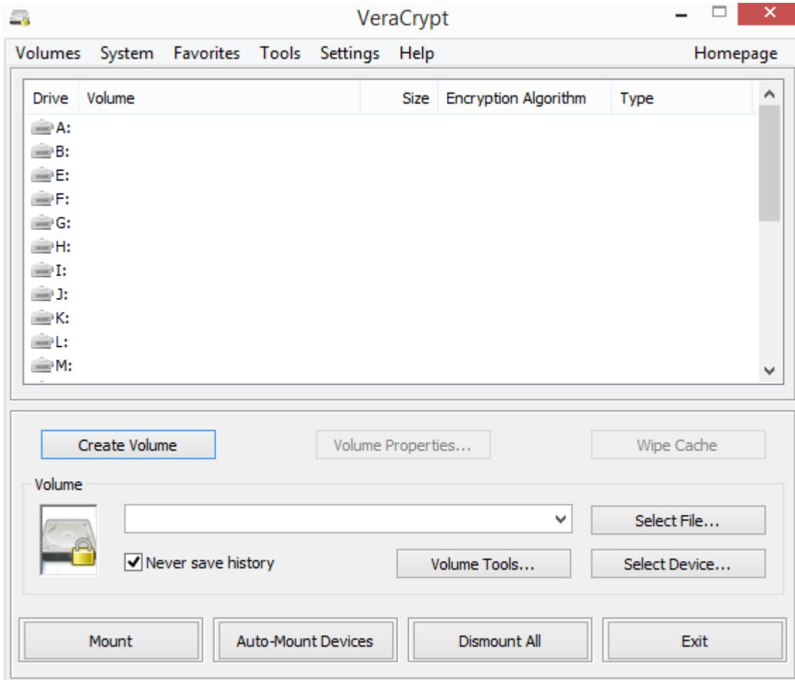
Über den Button „Create Volume“ erzeugt man mit Hilfe eines Assistenten einen verschlüsselten Container. Dieser beinhaltet später die vertraulichen Daten. Beim Einrichten eines Containers bietet VeraCrypt verschiedene Optionen an:
