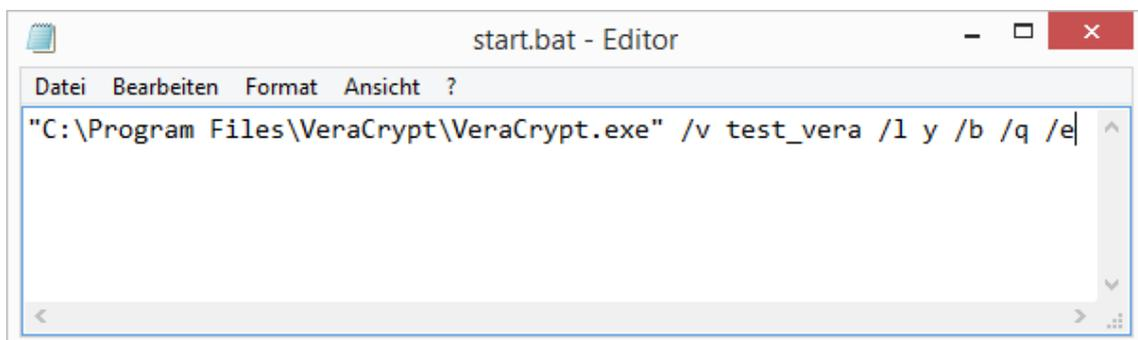
Das obige Beispiel kann einen Container mit Namen test\_vera, der sich im gleichen Verzeichnis wie das Script befindet, auf den Laufwerksbuchstaben Y einbinden.
